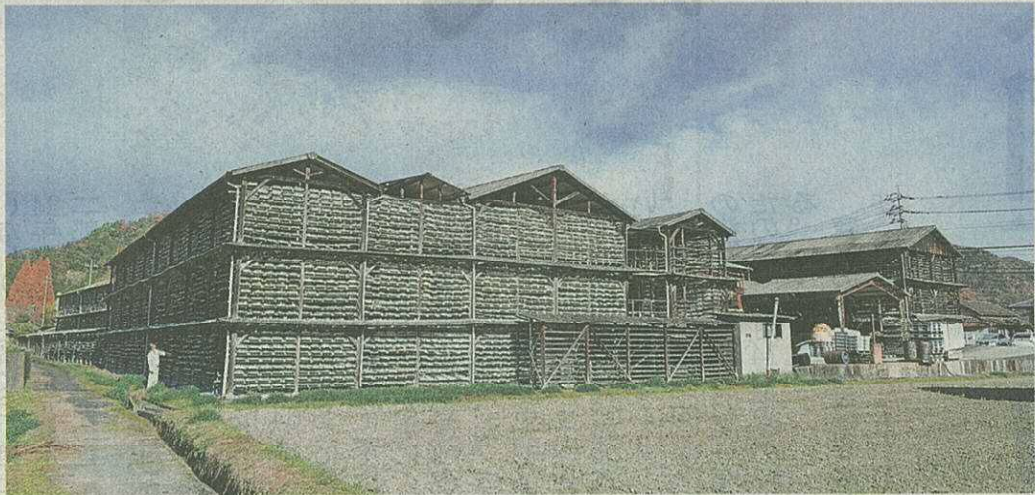
山陽クレール工業本社工場の乾燥棚。風が通り抜け、湿ったクレールを自然乾燥させる
